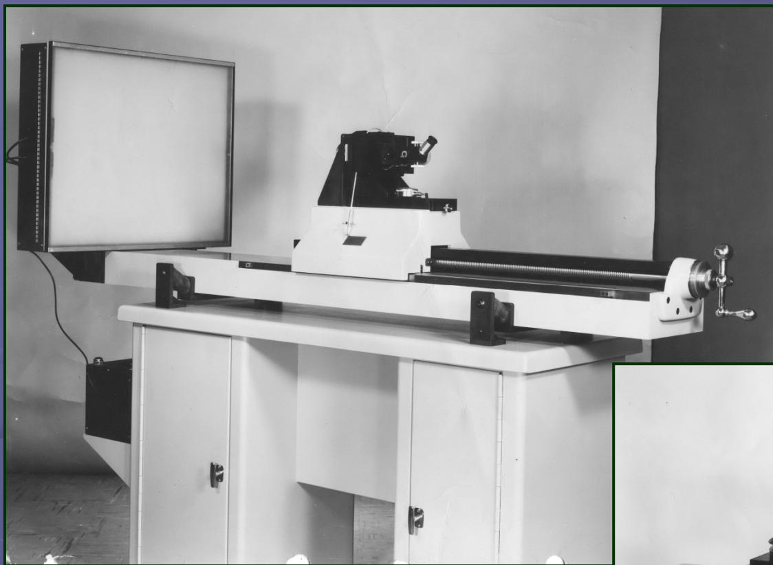
Уређај Mann Type 1003 Reduction Camera за снимање првог умањења (оригинални цртеж се снима и умањује 20× до 40×)
